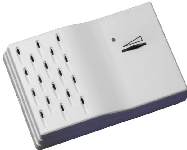
ADS-SMOKE je prostorové čidlo plynných znečišťujících látek vzduchu s analogovým napěťovým výstupem 0 - 10V a výstupním relé s nastavitelnou úrovni spínání. Čidlo vykazuje vysokou citlivost na nízké koncentrace plynných znečišťujících látek jako je např. oxid uhelnatý a vodík, které se nacházejí v cigaretovém kouři. Proto je vhodné pro ventilační systémy. Čidlo je vhodné i pro orientační detekci alkoholových par, pro detekci úniku plynů jako např. metan, propan-butan, zemní plyn apod.
